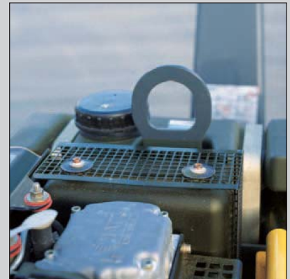
El gancho de suspensión por un punto central y las anillas laterales de fijación facilitan un transporte rápido y seguro.
