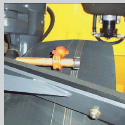
De serie: Rociado a presión suministra humedad uniforme - independiente de pendientes o nivel de llenado del depósito.
