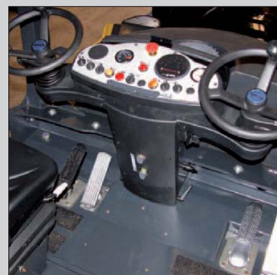
Dos puestos de conductor completos con asiento desplazable para un trabajo racional y buena visibilidad.
