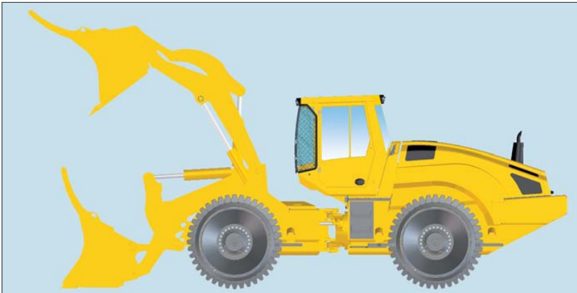
Compactador de basuras, versión con pala con plena altura para cargar camiones.
