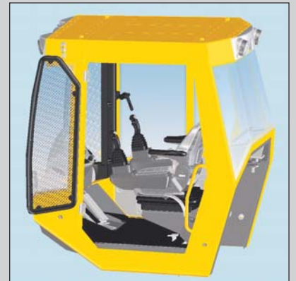
Confortable puesto del conductor con excelente visibilidad y mando por joystick.
